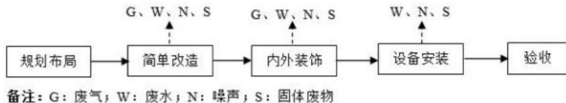
图 2-2 施工期工艺流程及产污节点图
