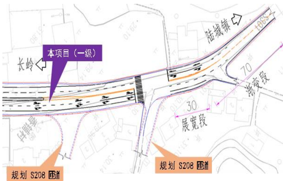
图 5.4.2-10 本项目终点平交预留及顺接设计图
