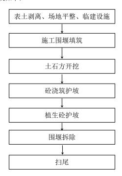
图 2-5 工程总体施工时序图
