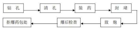
图 2-7 石方爆破工艺流程图
