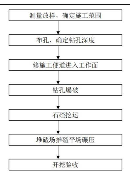
图 2-6 石方开挖作业程序
